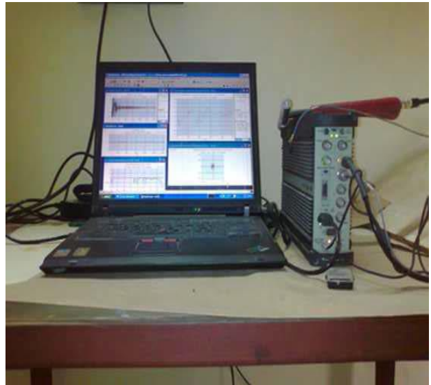
Fig. 4. FFT Analyser Set up
