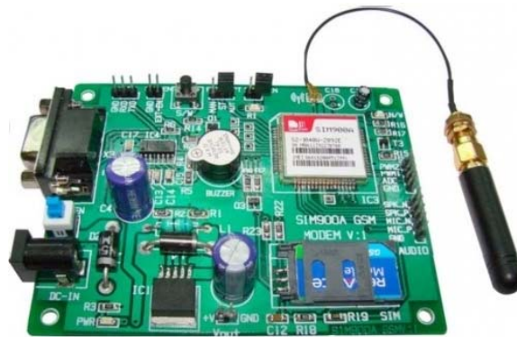
Fig.4. GSM Module (SIM800)
