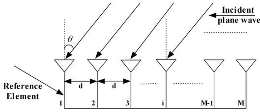
Fig. 1. Uniform linear array
