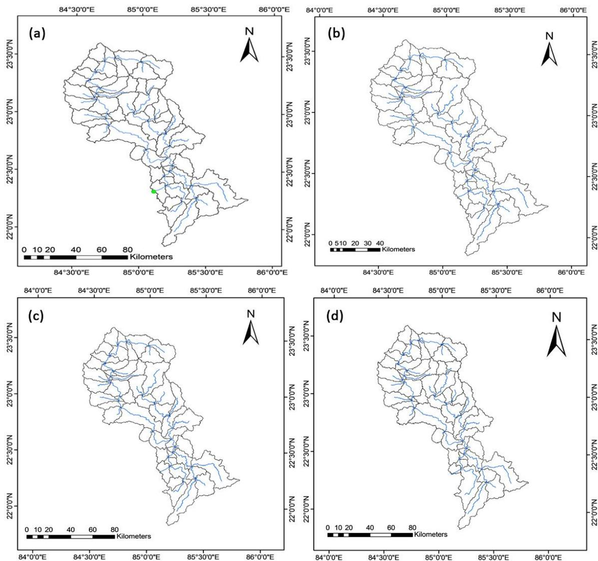
**Figure 5.** Sub basins derived from (a) AW3D30 DEM (b) CartoDEM (c) SRTM (d) ASTER DEM
