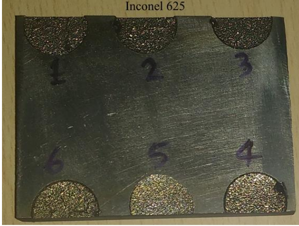
Fig. 3. EDMed Inconel 625 specimens
