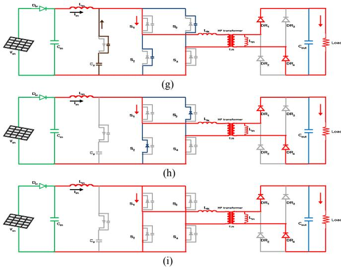
Fig. 2. Equivalent circuits of (a) Mode 1 (b) Mode 2 (c) Mode 3 (d) Mode 4 (e) Mode 5 (f) Mode 6 (g) Mode 7 (h) Mode 8 (i) Mode 9
