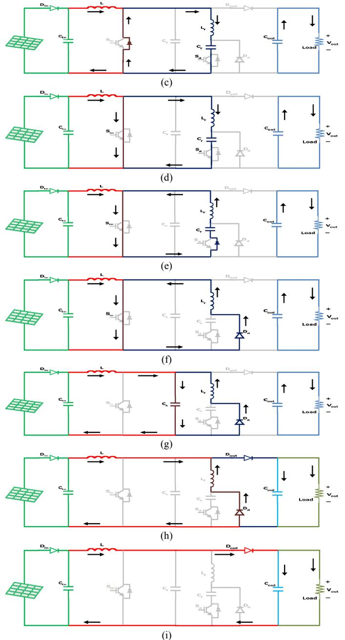
Fig.6. Equivalent circuits of (a) Mode 1 (b) Mode 2 (c) Mode 3 (d) Mode 4 (e) Mode 5 (f) Mode 6 (g) Mode 7 (h) Mode 8 (i) Mode 9
